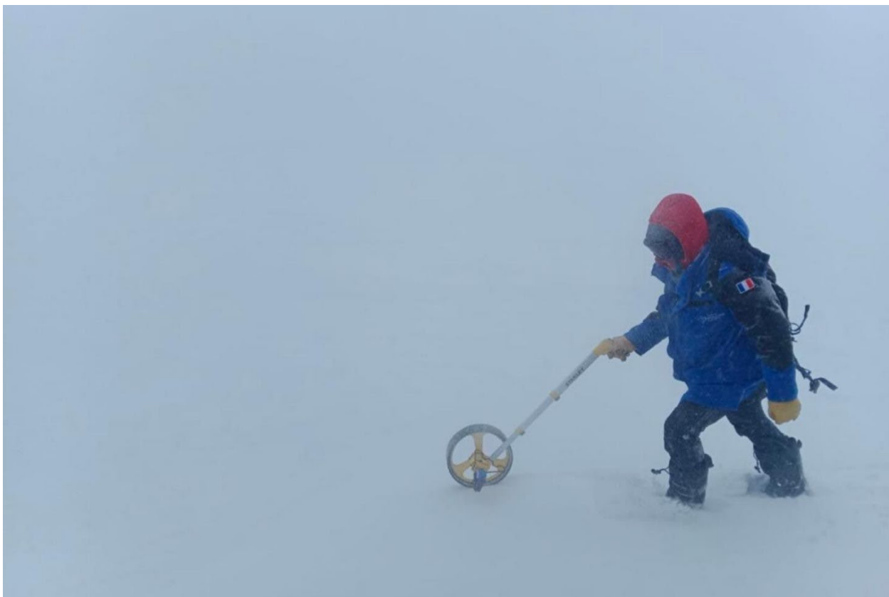
Figure 2 : Réalisation d'un levé topographique de la surface à l'aide d'une roue topographique en conditions de blizzard.
